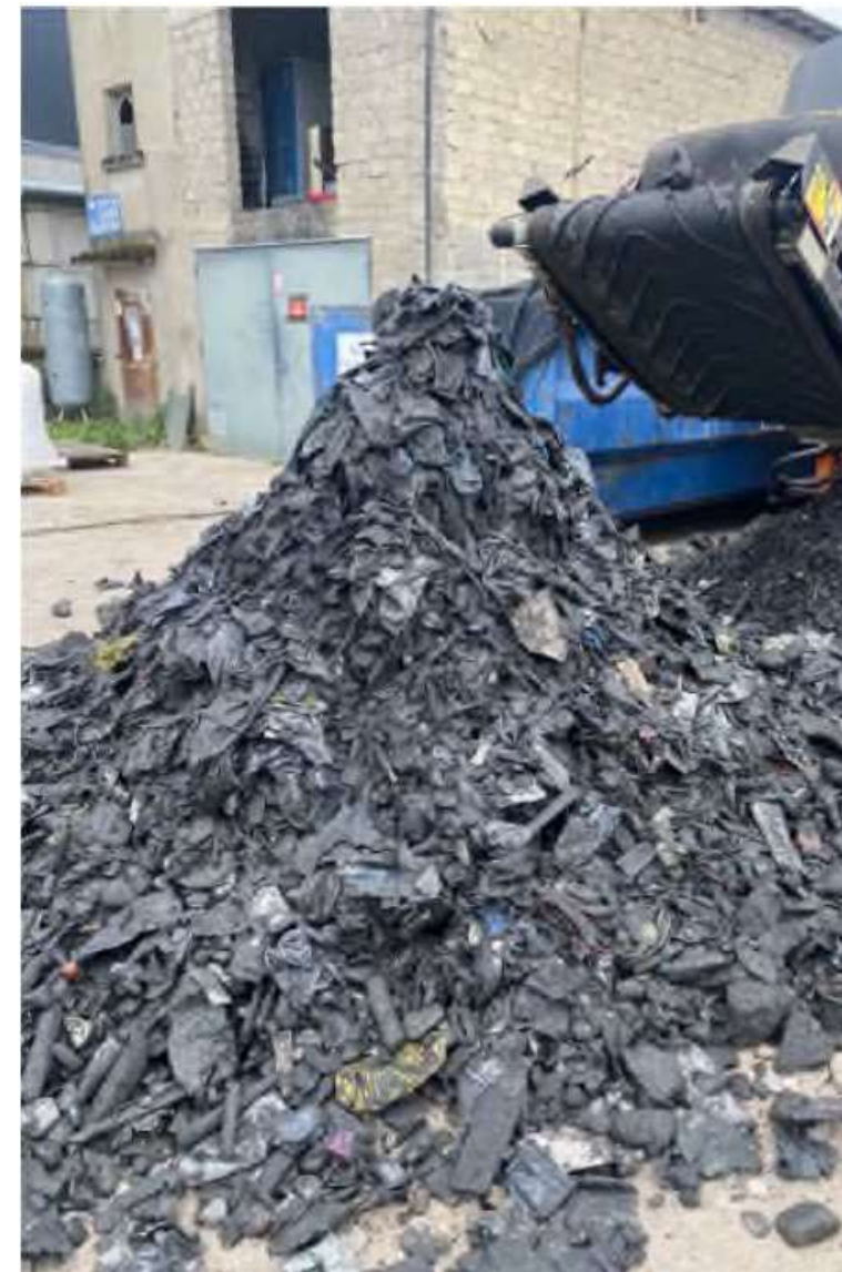
Séparation de la fraction grossière > 30 mm
