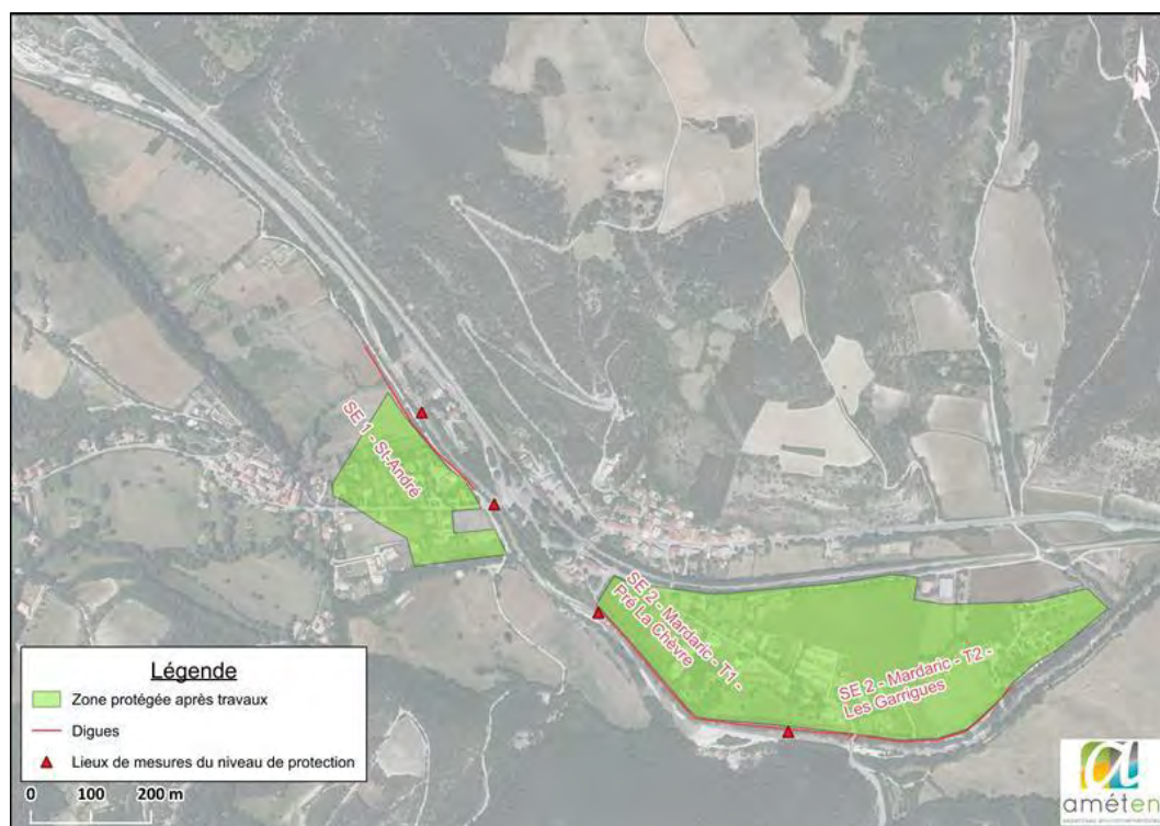
Figure 40 : Zone protégée après la mise en œuvre des travaux (Source : EDD, Améten - 2025)
