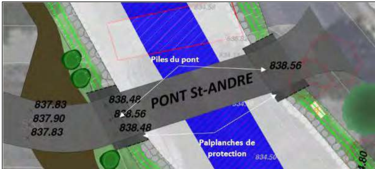
Figure 21 : Extrait du plan AVP présentant le principe d'aménagement et de transition entre le pont et les berges projet (Améten, 2025)
